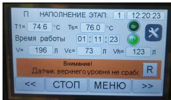
Рисунок 40 – На этапе «Наполнение» не сработал датчик верхнего уровня
