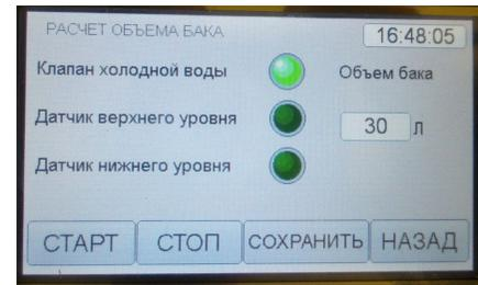
Рисунок 13 – Расчет точного объема бака по датчику верхнего уровня
