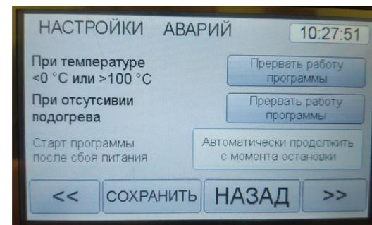
Рисунок 20 – Настройки работы программы в случае обнаружения аварийных ситуаций.
