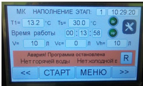
Рисунок 32– Аварийная остановка программы в случае отсутствия воды
