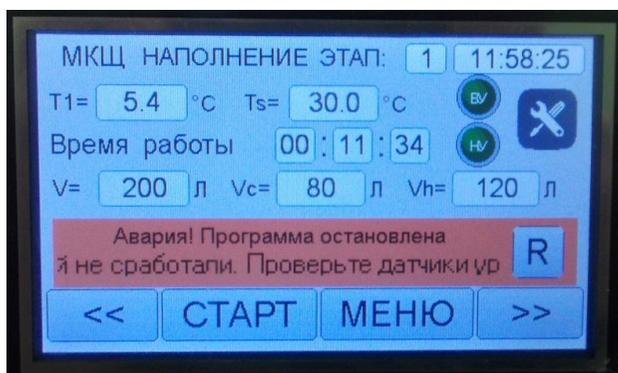
Рисунок 33 – Аварийная остановка программы на этапе «Наполнение» в случае если датчики нижнего и верхнего уровня не сработали
