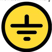
Рисунок 2 – Знак заземления
