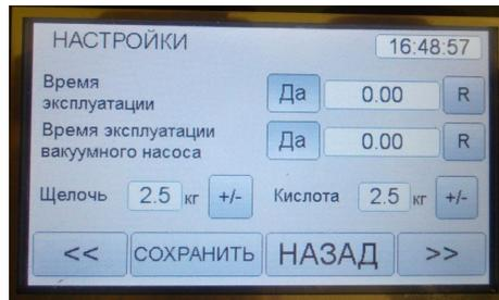
Рисунок 14 – Меню установки дозы щелочи и кислоты
